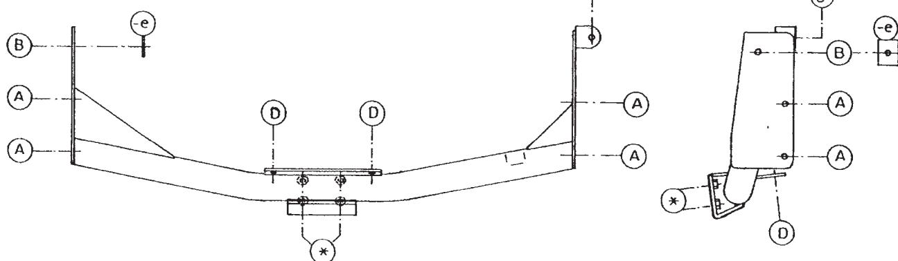
De door GDW gebruikte verf is enkel een grondlaag. Het is noodzakelijk na montage de trekhaak te voorzien van een extra bescherm laag. GDW a mis seulement une couche de peinture primaire. Il est nécessaire d'appliquer encore une couche supplémentaire après montage.
